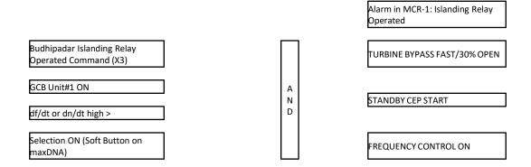
LOAD-GENERATION BALANCE SCHEME CONFIGURED IN UNIT#1 MAXDNA CONTROL SYSTEM
